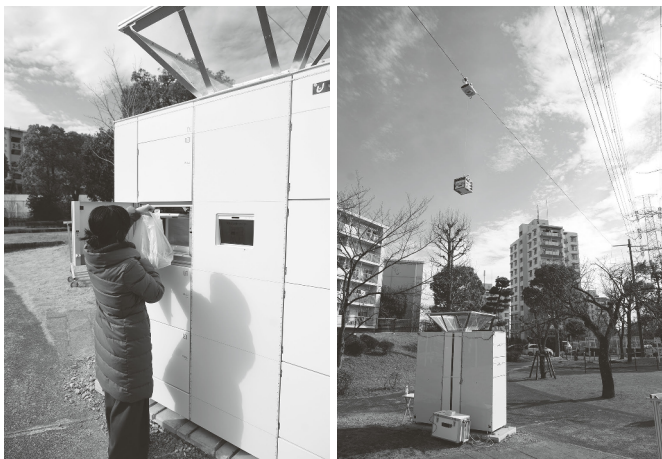
空中配送ロボットが荷物をおろす様子。左は注文した団地にお住まいの方が荷受けしている。
